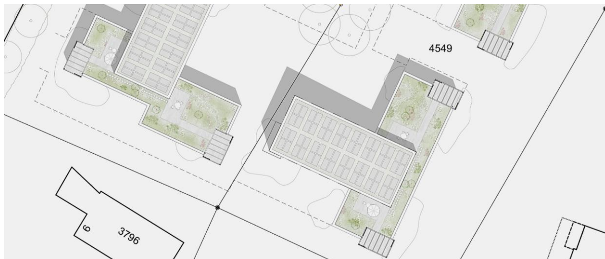
Abb. 41: Dachgestaltung (Ausschnitt Richtprojekt)
