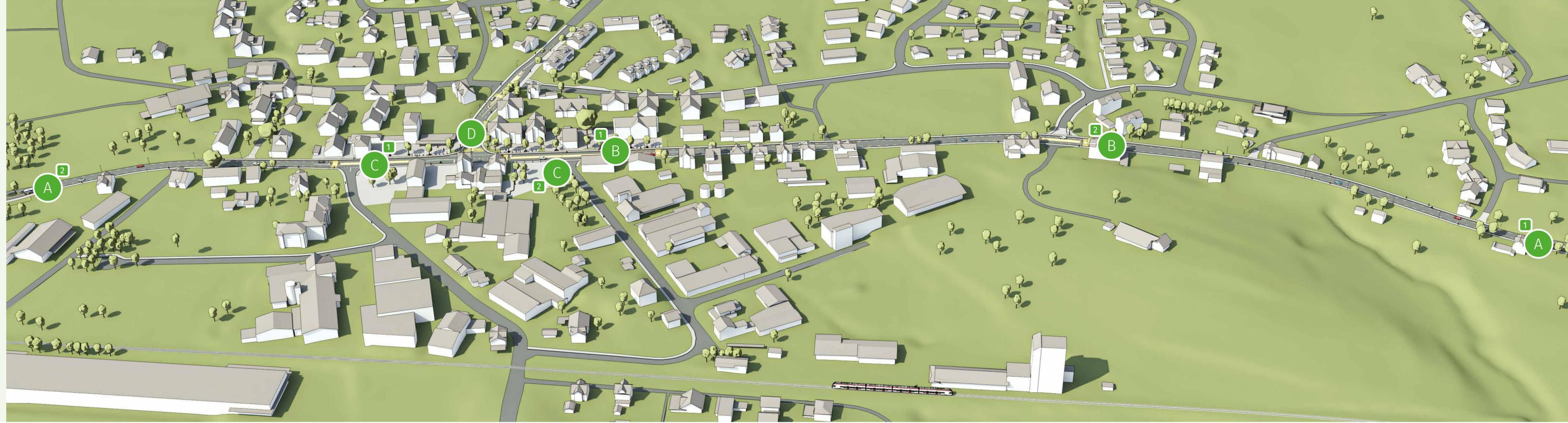
**A** Der Beginn und das Ende des Dorfes werden sichtbar markiert. Bis zur Dorfmitte werden beidseitig Velostreifen geführt. Der motorisierte Verkehr teilt sich die Hauptfahrbahn ohne Mittelmarkierung. Das Tempo wird damit auf natürliche Weise reduziert und die Sicherheit für Velofahrerinnen und Velofahrer gesteigert.
