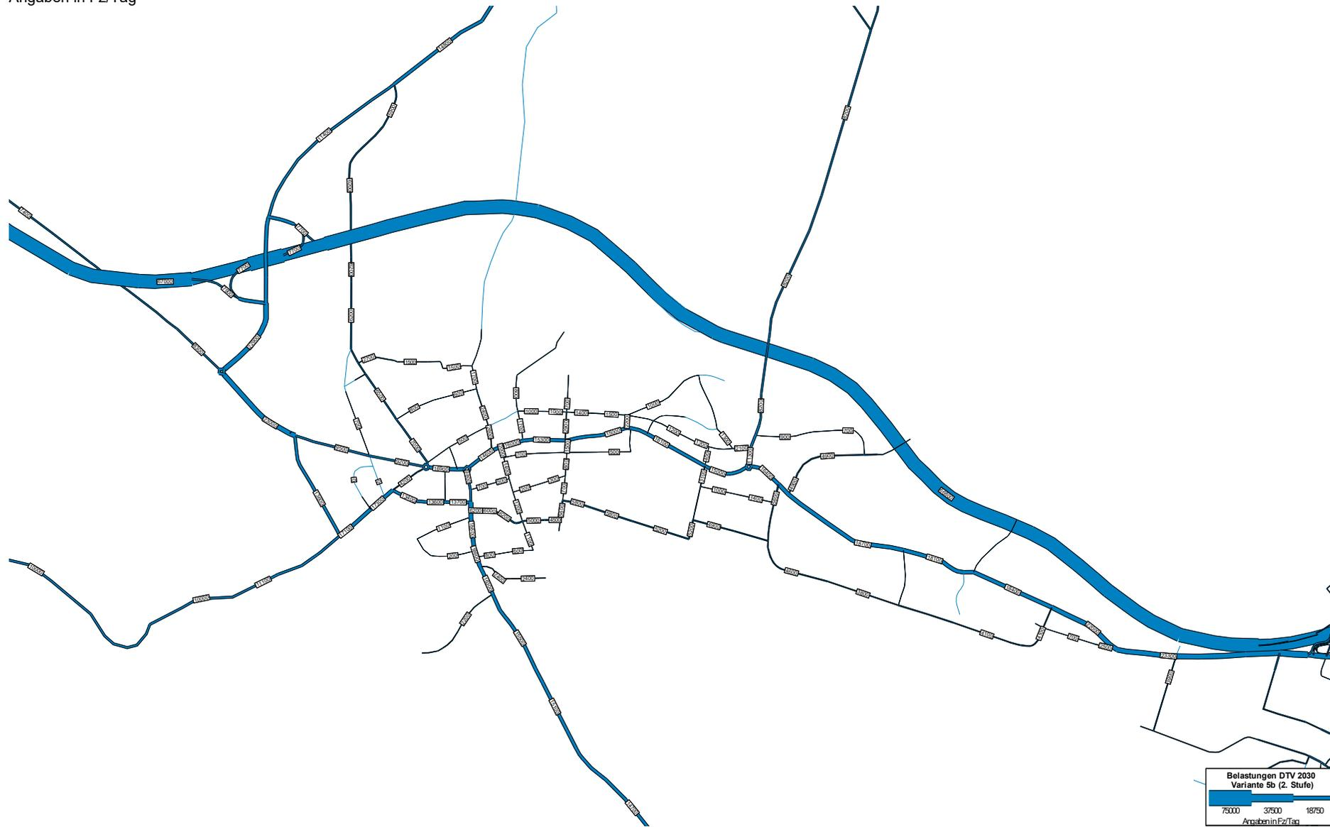
**Belastungsvergleich DTV 2030, Variante 5b mit Referenzzustand 1 (2. Stufe)**
