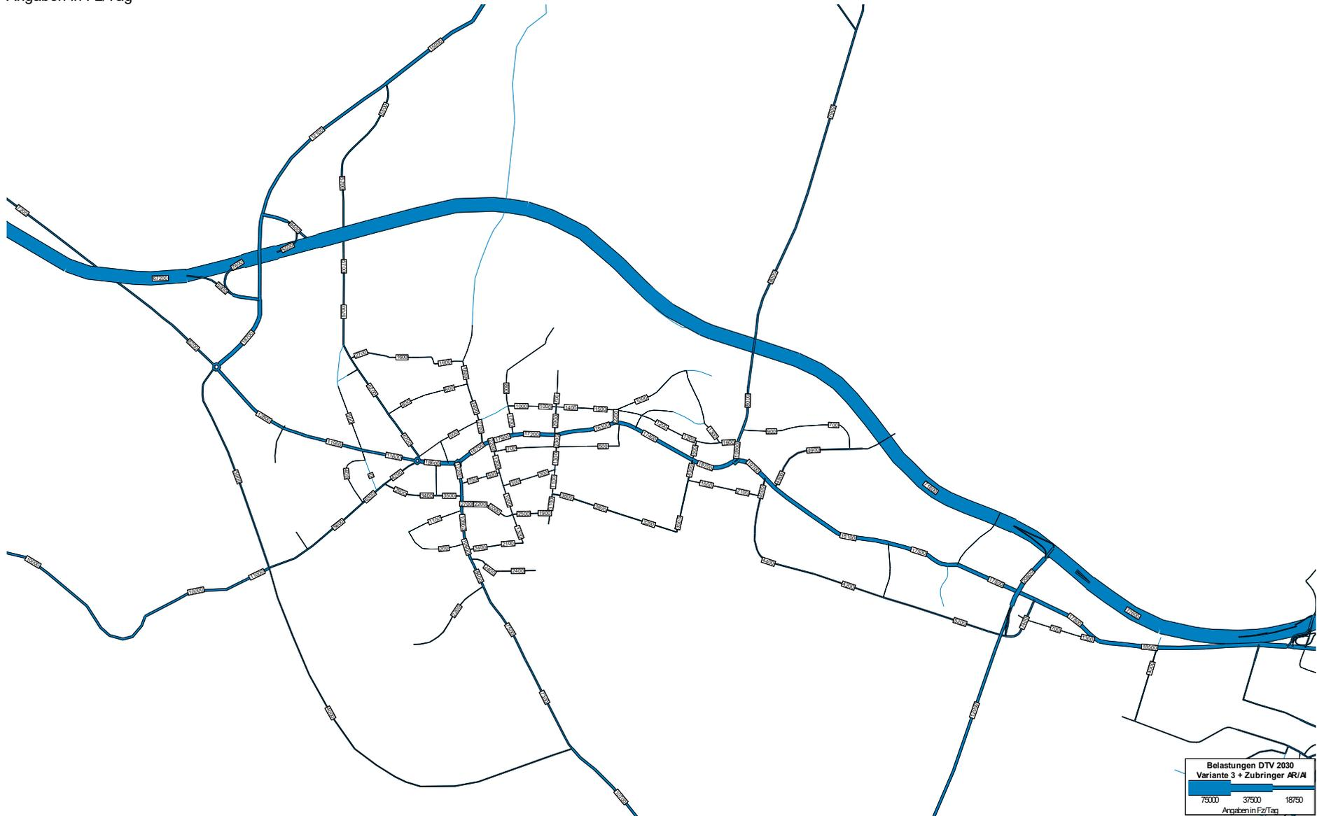
**Verkehrsbelastungen DTV 2030, Variante 4b + Zubringer AR / AI (2. Stufe)**
