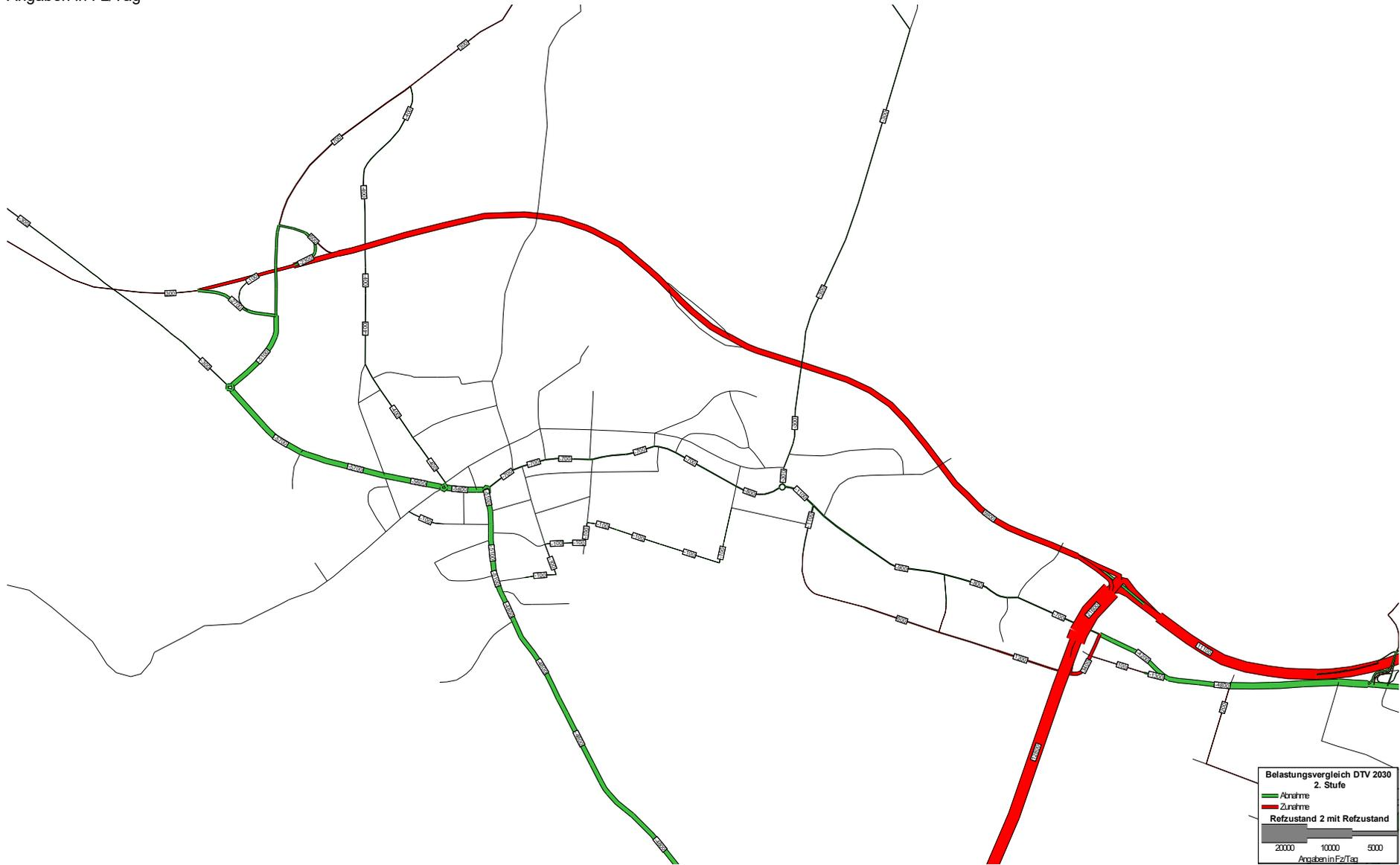
**Verkehrsbelastungen DTV 2030, Variante 2b + Zubringer AR / AI (2. Stufe)**
