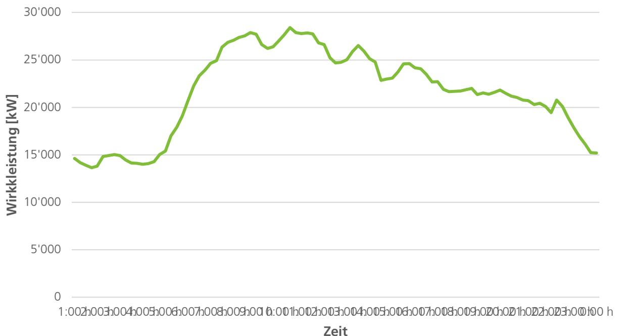
Abbildung 2: Beispiel eines Tageslastgangs des Verteilnetzes der Stadtwerke Gossau
